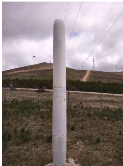
Figura 6. Aerogenerador de Vortex (Fuente: CIEMAT)
