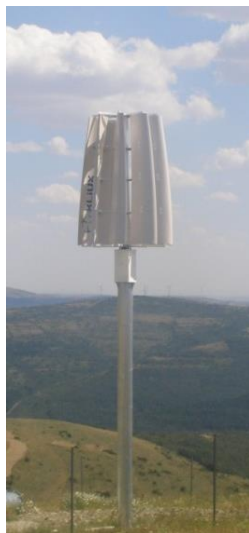
Figura 5. Aerogenerador de Kliux (Fuente: CIEMAT)
