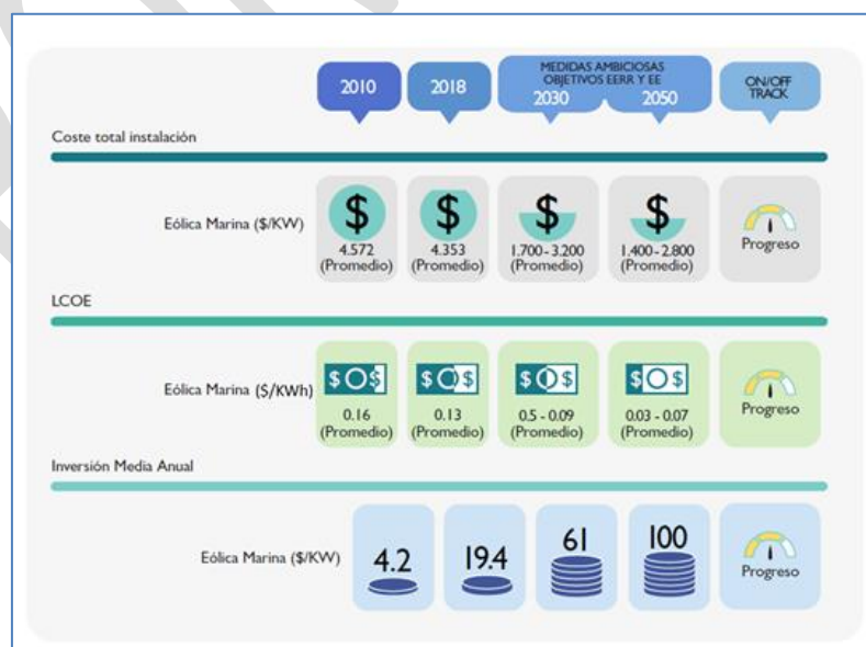
FIGURA 10: Valor actual y previsión a futuro del coste total, LCOE e inversión anual media de los proyectos de eólica marina. Fuente: Future of Wind. Deployment, investment, Technology, grid integration and socio-economic aspects. IRENA 2019
